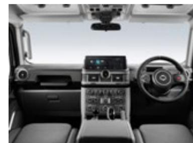
سيارة Grenadier مصممة لتحتمل ظروف الاستخدام القاسية بفضل المواد المتينة المستخدمة في جميع أسطح السيارة. كما أن أرضية السيارة مغطاة بطبقة من المطاط؛ إذ يمكن تنظيف السيارة بالمياه وتصريفها عبر الفتحات المزودة المخصصة لذلك. وتوفر مقاعد Recaro المقاومة للتلطيخ وللمياه الدعم والراحة اللازمين لقائد السيارة على الطرق الممهدة أو الوعرة على حد سواء. ومن التجهيزات المتاحة بساط الأرضية والتجديد بالجلد للمستخدمين الذين يحرصون على تنظيف أنفسهم من الطين والرمل قبل دخول السيارة.
